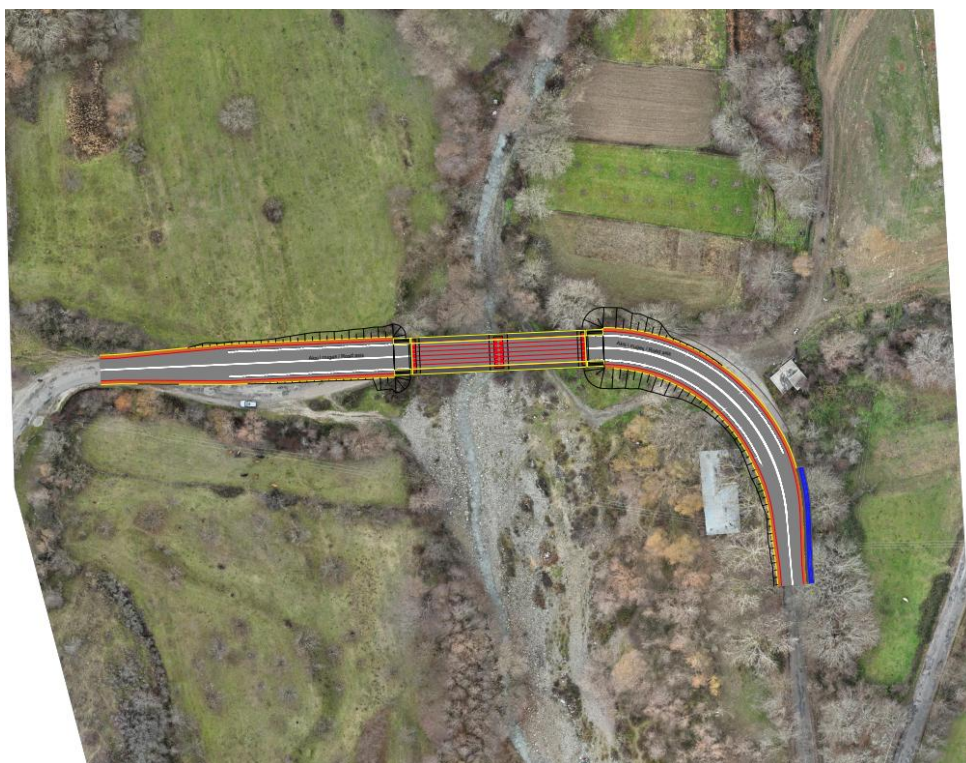
Figura 5. Pamje ajrore e urës ekzistuese dhe skema përfundimtare e projektimit të urës së re
